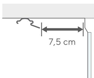
Se si utilizzano le staffe per l'installazione a soffitto, assicuratevi di montarle ad almeno 7,5 cm di distanza dal telaio della finestra e da eventuali bocchette o maniglie sporgenti. In questo modo, le lamelle avranno spazio sufficiente per aprirsi e chiudersi correttamente.
