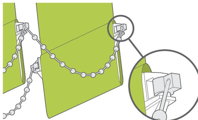
Inserite il peso nella tasca inferiore della lamella. Agganciate la catena di stabilizzazione ai pesi; una catena correrà lungo la parte posteriore e l'altra lungo la parte anteriore. Se ci sono fermagli in eccesso, potete semplicemente tagliare il cordoncino all'altezza dell'ultimo fermaglio fissato a un peso.
