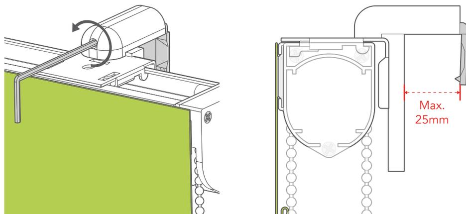
Utilizzate la brugola in dotazione per aprire la staffa. La staffa si apre fino a un massimo di 25 mm.
